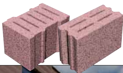
Tvárnice Liapor SL z lehkého keramického liaporbetonu dosahují při tloušťce zdiva 365 mm součinitele prostupu tepla U = 0,21 \text{ W/m}^2\text{K} , mají i vynikající zvukově izolační vlastnosti, jsou staticky a požárně velmi odolné. LIAS VINTÍŘOV
